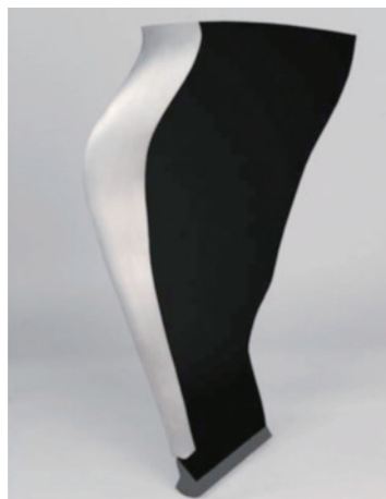
图2 三维编织树脂传递模塑成型复合材料叶片
